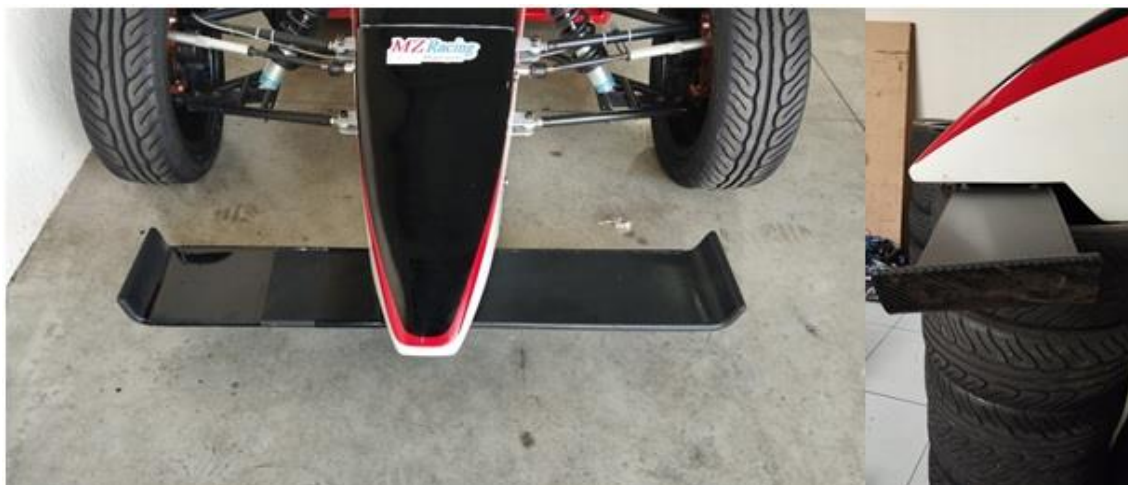
6.7.1 – Asa traseira Chassi Evolution 2 ( conforme foto ) Largura: 230,5 mm, Comprimento total : 1240 mm
